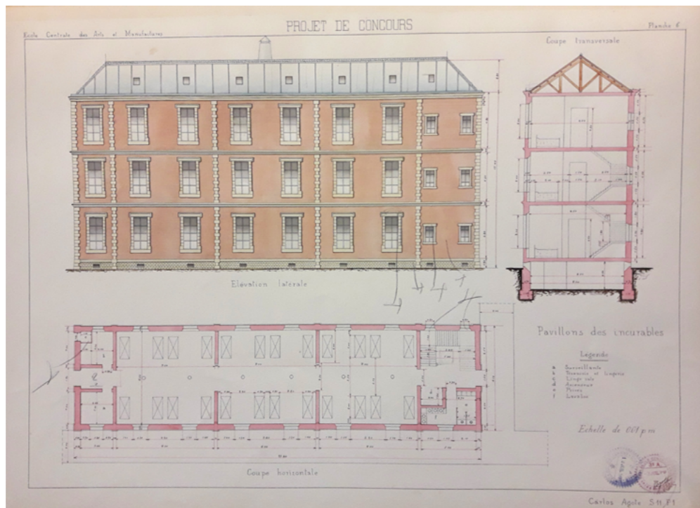
Figura 9. Criterios de dimensionamiento y modulación de los pabellones tipo, explicados con croquis a mano en tinta, cotas y textos, en la memoria descriptiva del proyecto final de la ECP. Fuente: Agote (1890). | Figura 10. Pabellón de incurables. En relación con los cálculos realizados en la memoria descriptiva se dibujan los épures en láminas de gran formato del proyecto final de la ECP. Fuente: Agote (1890).
