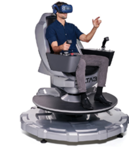
Figura 4. Simulador multipropósito S1, empresa Delta 3, el simulador sirve para capacitar operarios en maquinaria pesada, evitando riesgos simulando situaciones críticas gracias a la realidad aumentada. Recuperado de http://www.deltatres.com/
